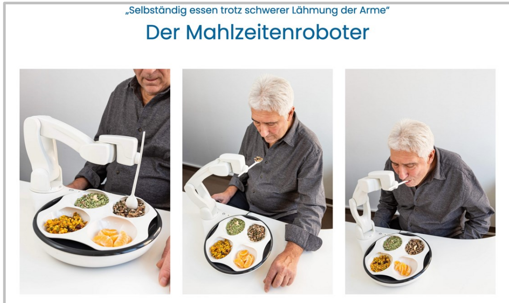
Abbildung 3: Illustration der Funktionsweise eines Mahlzeitenroboters im Service-Center
